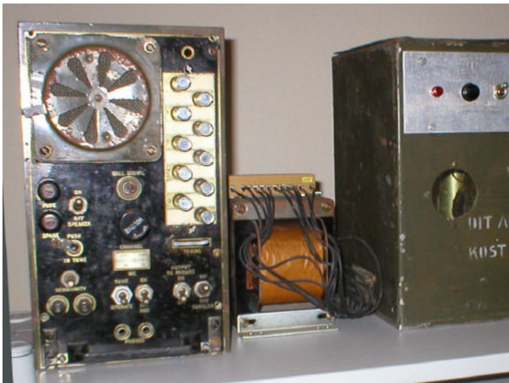
Bild 2: Der RXBC-683. Recht oben die mechanischen Kanaltasten.
