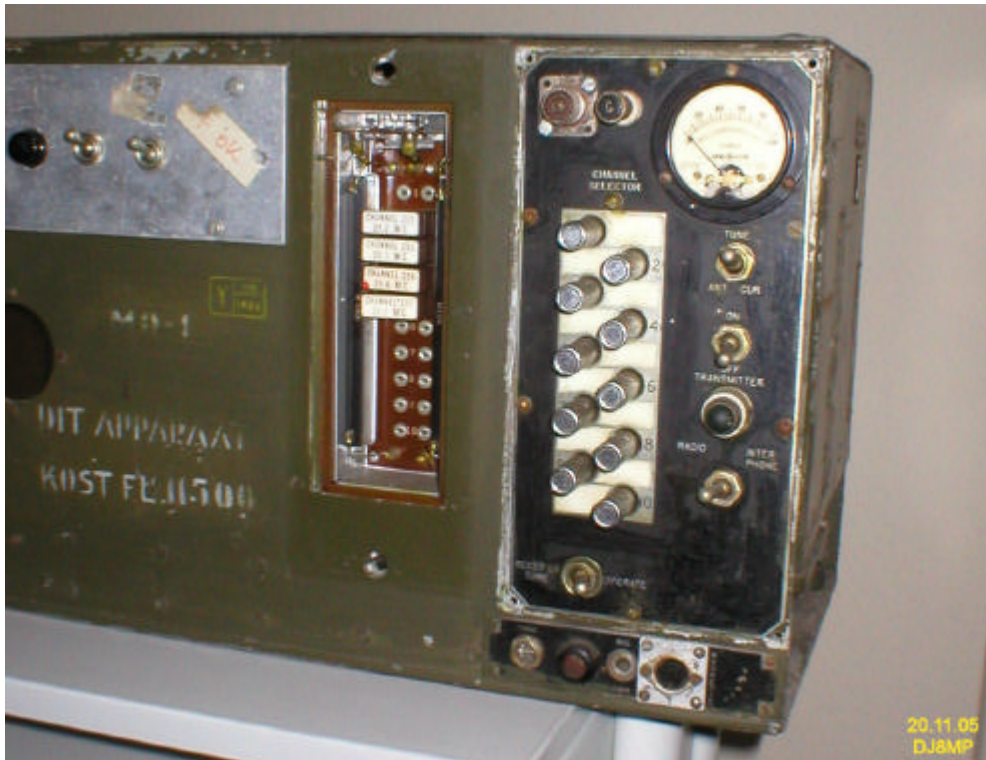
Bild 3: Der TX BC-604. Der Quarzfach-Deckel wurde entfernt. Man beachte links unten den Aufdruck: "DIT APPARAAT KOST FL 11500". Er weist darauf hin, dass das Gerät bei der holländischen Armee eingesetzt war und man die Soldaten dadurch zu einem pfleglichen Umgang anhalten wollte.
