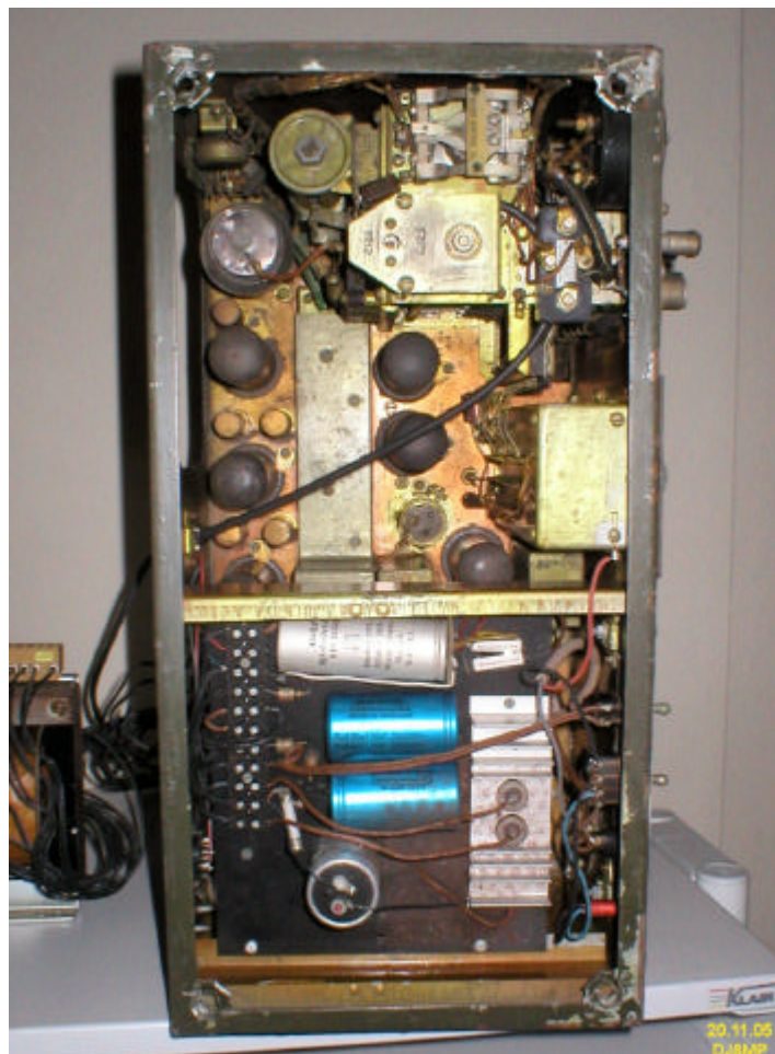
Bild 4: BC-604 geöffnet. Oben PA, unten nachträglich eingebautes Netzteil
